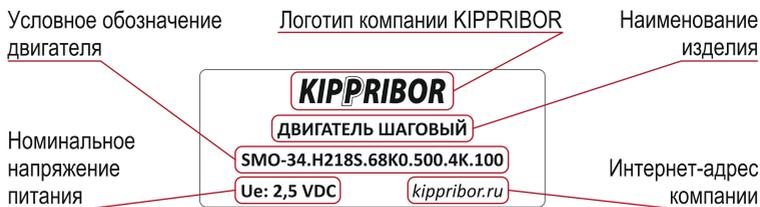
Рисунок 2 – заводская маркировка шаговых двигателей
