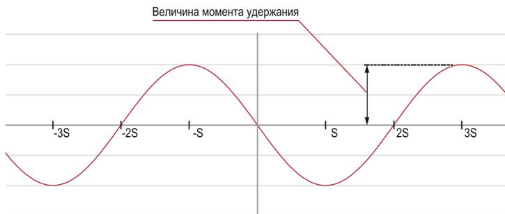
Рисунок 33 – момент удержания при одной запитанной обмотке ( $S$  – угловой шаг в радианах)
